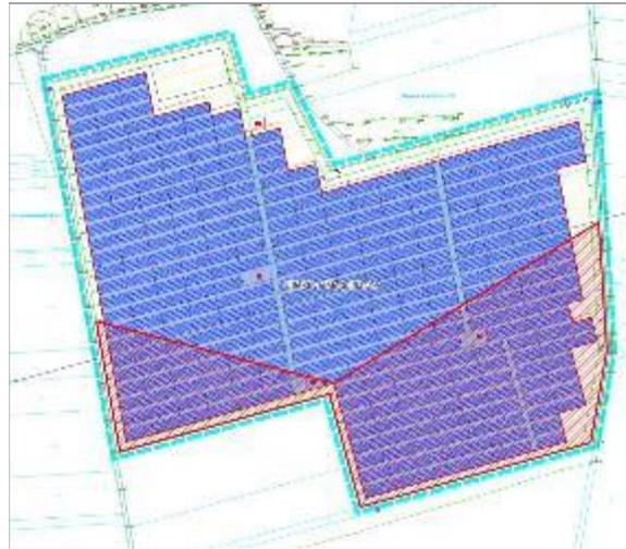
Abbildung 1: Ursprüngliches Konzept. Rot markiert: Bereiche von denen Blendwirkungen ausgehen können. [12]
